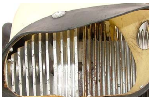
Før heving av ducter inlet. (Litt uheldig med at gummi-kanten henger nedover og skjermer.
